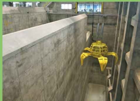
●ごみピット・ごみクレーン ごみピットに投入されたごみは、ごみクレーンにより攪拌されたあと焼却炉へ運ばれます。
