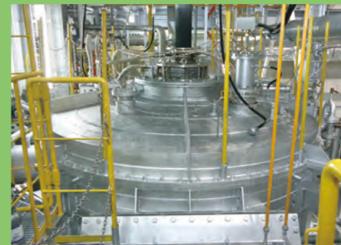
●灰溶融炉 焼却灰を、約1200℃の高温で溶融し、減容・無害化して、資源化を図ります。
